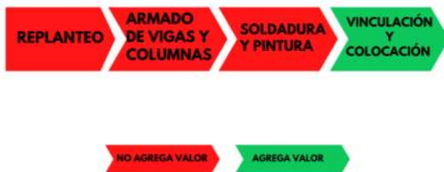
Figura 5. Proceso armado de estructura metálica
