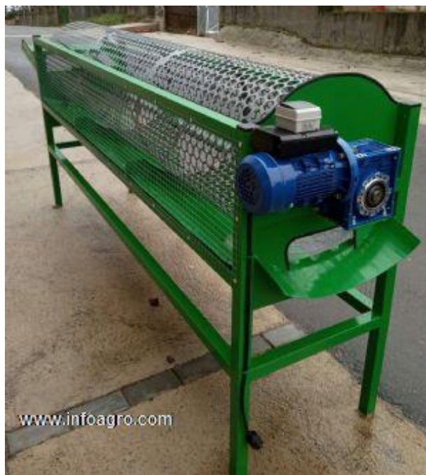
Gráfico 19: Máquina calibradora de nueces. Fuente: Infoagro.
