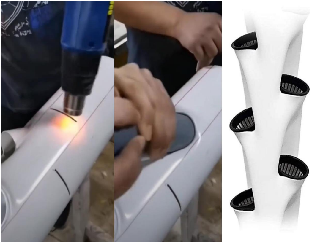
Imagen 4.5 Proceso de formación de aberturas
