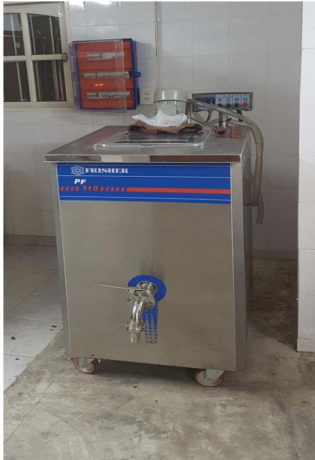
*Máquina que se utiliza para pasteurizar la mezcla previamente, en la fabricación de helado. En propiedad de la empresa.*
