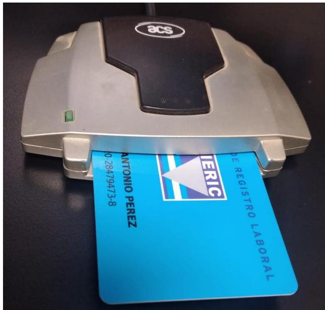
Figura 11. Lectora de tarjeta magnética. Fuente propia
