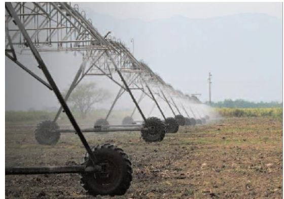
El riego de los cañaverales requiere además de una red de drenaje. Esto se debe a que el riego puede producir un efecto indeseado: el ascenso de la napa y la salinización del terreno, es decir, el incremento de las sales contenidas en el suelo, que puede alcanzar niveles tóxicos para las plantas, principalmente porque las sales dificultan la absorción de agua por las raíces. Para evitar esto, Ledesma instaló caños subterráneos perforados que deprimen la napa y evacuan el exceso de agua.
