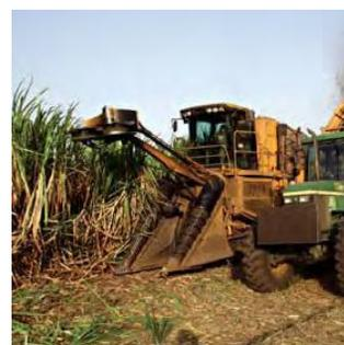
El corte de la caña y su separación de la malhora se realizan con máquinas cosechadoras, que recorren el cañaveral surco por surco acompañadas por carros volcadores, remolcados por tractores de doble tracción.
