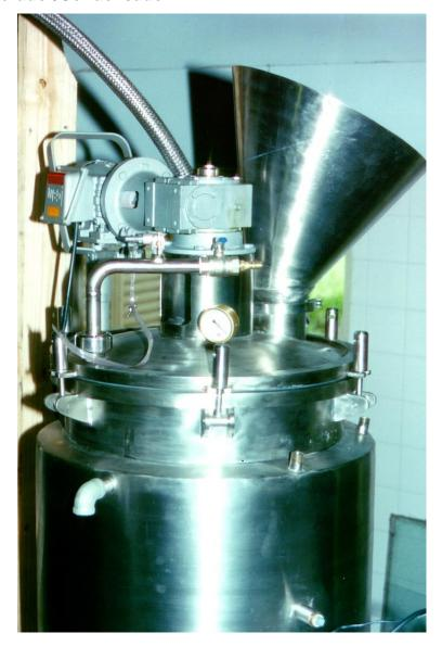
Una vez que se tiene toda la mezcla filtrada en el tanque de depósito, se la envía nuevamente al tanque macerador, que mediante el cambio de la tapa se modifica la función para concentración de extractos. En este paso se realiza la evaporación a temperaturas controladas de entre 45° y 50° hasta que se llegue a la concentración deseada de 80%. El alcohol evaporado se
