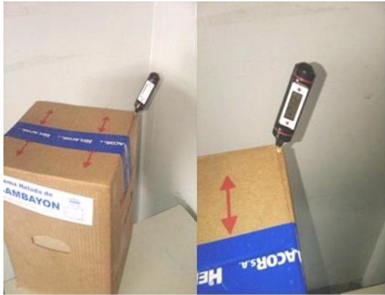
3. Dejar estabilizar la temperatura hasta que la misma quede fija en el display digital.
