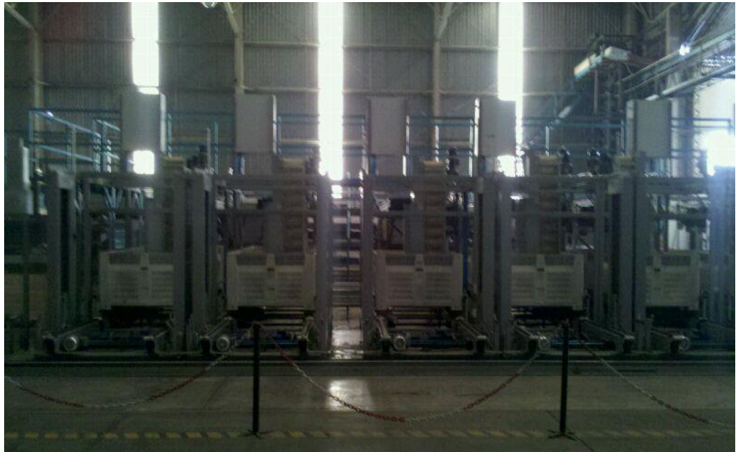
Figura 14. Recolector de Bins con fruta después de preselección.
