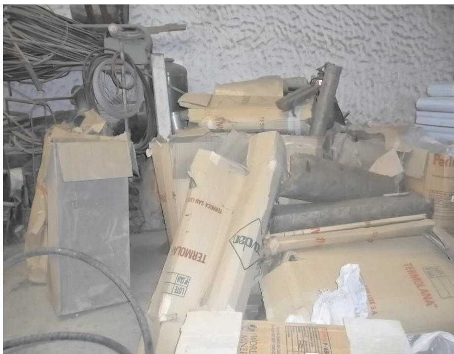
Figura N° 10. Desorden en Depósito de cajas de medias cañas de lana mineral.
