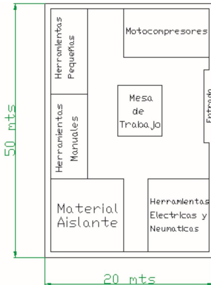
Figura N°7. Sectorización del Depósito
