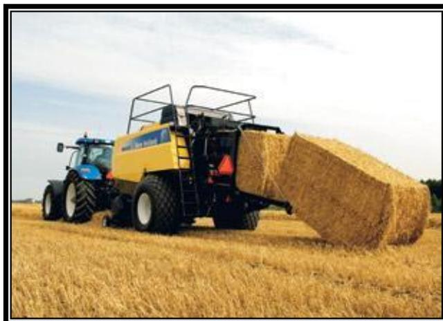
**Figura 10.- Modelos BB-A.-** Cuenta con un sistema exclusivo de atado con seis hilos y utiliza doble nudo, lo que garantiza una excelente confiabilidad en el amarrado de los fardos. Los ventiladores vienen de serie y los nuevos compartimentos, de formato redondeado, aumentan
