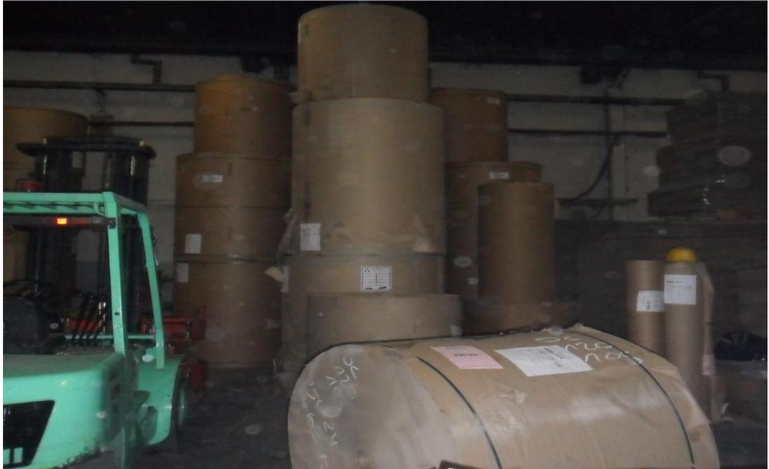
Este rollo, alimenta una máquina corrugadora, la cual presiona el papel entre dos rodillos y le dispara vapor, dándole forma ondulada.
