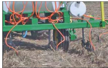
Figura 10: Equipo para aplicar abonos líquidos en campos con cobertura de residuo de cosecha.
