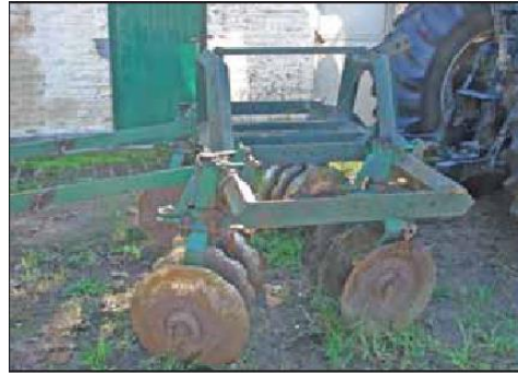
Figura 5: Equipo de cuatro paquetes utilizado para el picado de trocha.
