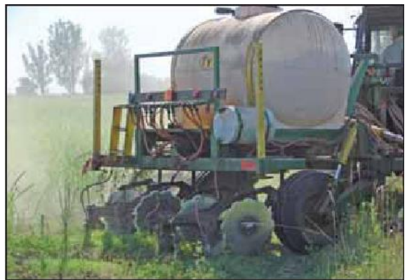
Figura 7: Equipo para la aplicación de fertilizante líquido.
