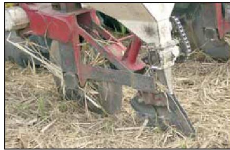
Figura 9: Equipo para aplicar abonos sólidos en campos con cobertura de residuo de cosecha.
