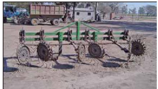
Figura 8: Equipo para retirar el residuo de la línea de brotación de los surcos.
