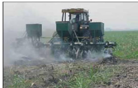
Figura 6: Equipo para la aplicación de fertilizante sólido, ancho de labor de tres surcos.
