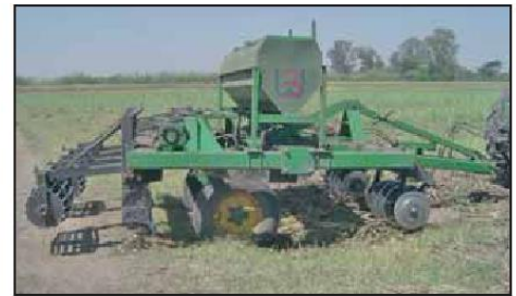
Figura 11: Equipo multipropósito que rompe capas compactadas y aplica fertilizante en cañaverales con cobertura de residuo de cosecha.
