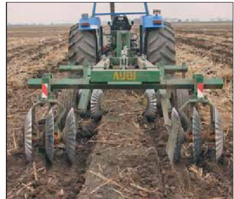
Figura 13: Equipo para incorporar el residuo de cosecha en el suelo.
