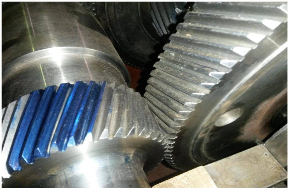
Estos engranajes antes de ser entregados al Ingenio Trinidad, se los pintó parcialmente de azul para verificar que exista contacto con la otra parte en la superficie suficiente.
